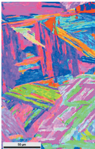
Распределение ориентировок в высокопрочной стали
