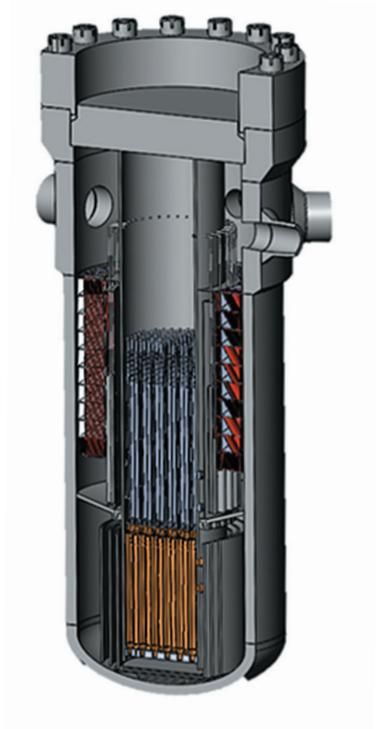
Конструкторская проработка интегрального ядерного реактора
