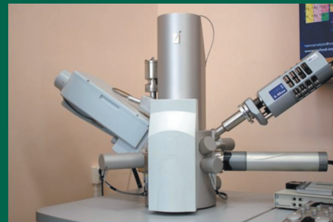
Сканирующий электронный микроскоп Мира
