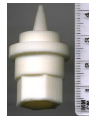
Сопло газо-газового инжектора для электрохимической энергоустановки, «напечатанное» на 3D-принтере.
